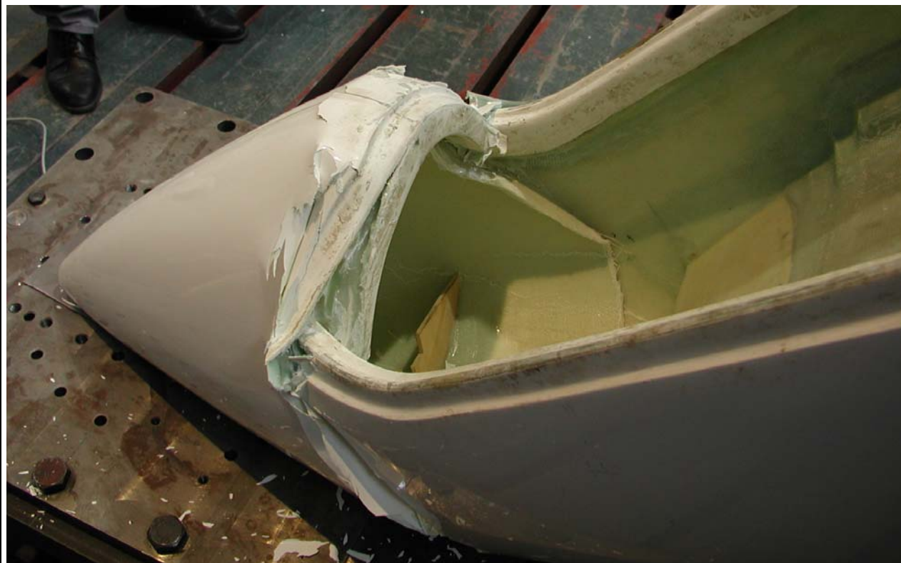
Foto 6. Poškození po ukončení fáze III
