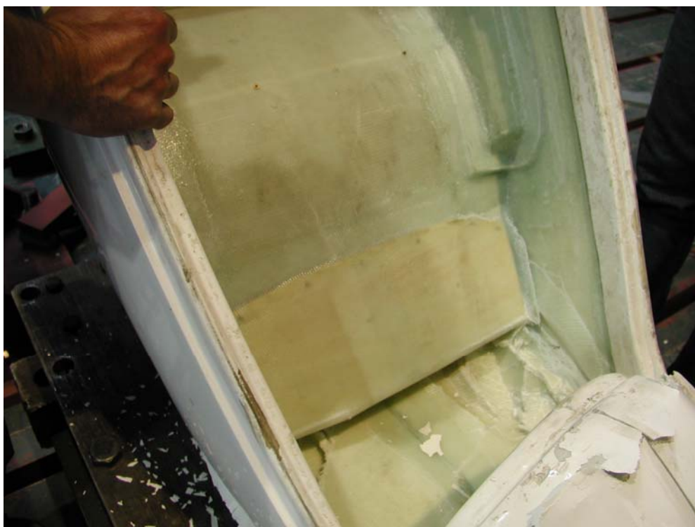
Foto 9. Poškození po ukončení fáze V
