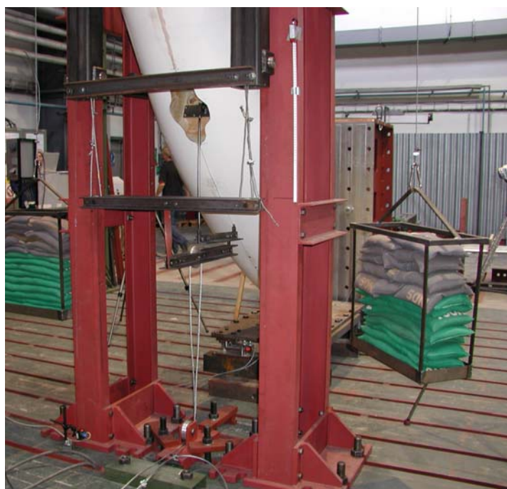
Obrázek 2: Detail lanového mechanismu a vahadla a hydraulického válce.
