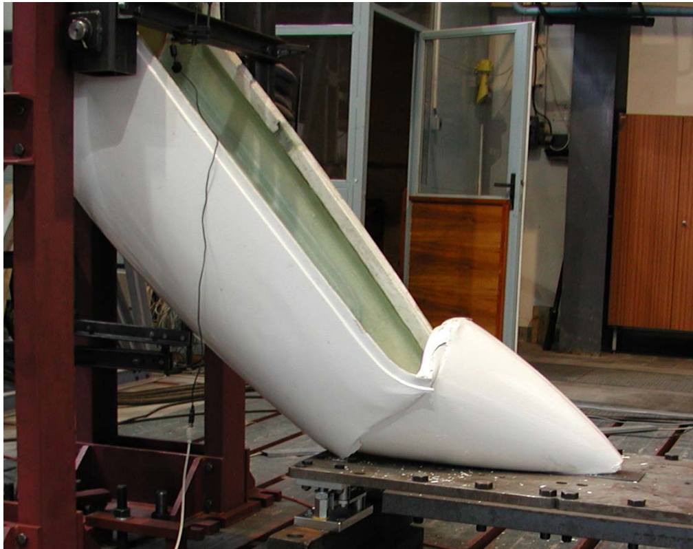
Foto 5. Poškození po ukončení fáze I.
